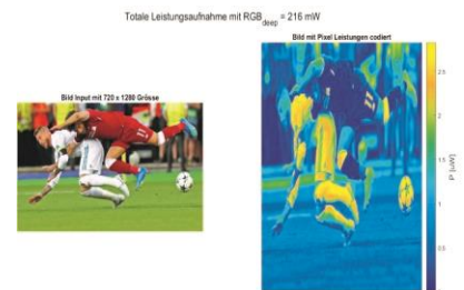
Bildverarbeitung und Leistungsberechnung eines farbigen Bildes. Links das Original und rechts das auf Pixelebene leistungsbezogene farbkodierte Inputbild.
