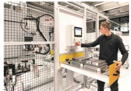
Befüllung der Roboterzelle mit Batteriezellen
