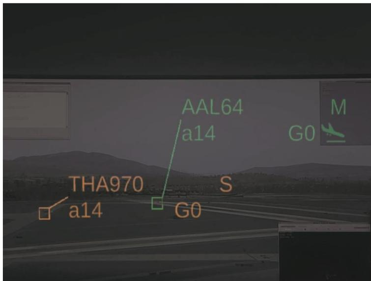
Die TowerLens 2.0 Darstellung überlagert die Aussensicht des X-Plane 11 Flugsimulators im Human Factors Engineering Labor der ZHAW
