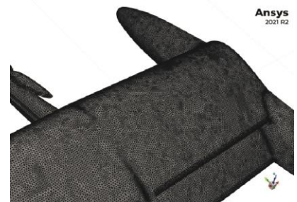
Graphische Darstellung des Oberflächen Netzgitters mit ANSYS Meshing.
