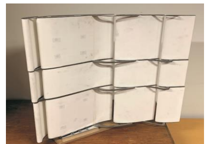
Das Multi-Element Flügelprofil besteht aus einem Slat und zwei Flaps. Auch dieses Profil wurde im Windkanal bei verschiedenen Anstellwinkeln getestet. Ausserdem wurde die Distanz zwischen dem Profil und den Flaps verändert.
