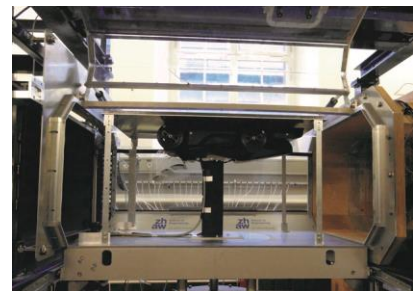
Der Aufbau des 1:4 Modells im Windkanal
