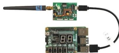
Die Datenstation besteht aus einem BLE-Empfänger (oben) und einem Raspberry Pi (unten), welcher die Messwerte in einer Datenbank abspeichert und über eine Webseite zur Verfügung stellt.
