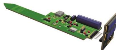
Der Solarprint (rechts) des Pflanzensensors wird über eine Steckverbindung an den Hauptprint (links) angeschlossen, auf welchem die einzelnen Sensoren und der Controller bestückt sind.
