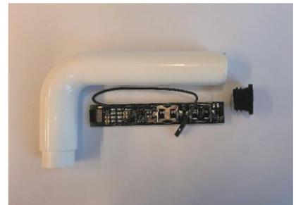
Das Bild zeigt den Aufbau des Türgriffs. Dabei wird der entwickelte Sensorprint in einen herkömmlichen Griff eingebaut.
