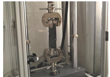
Eingespannter Prüfkörper in der Zugprüfmaschine.
