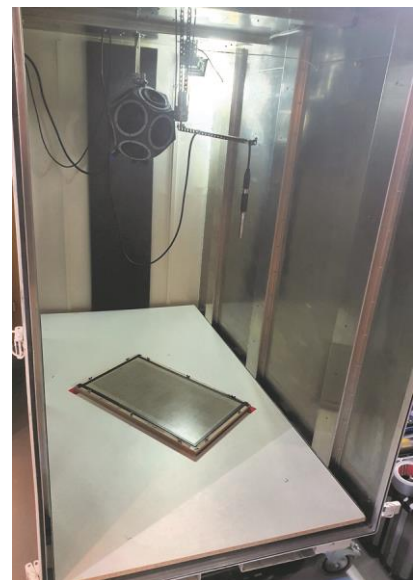
Für den Schallabsorptionstest benutzte Modenverwirbelungskammer. Die Kammer kann mithilfe eines Deckels geschlossen werden und ist mit einem Dodekaeder-Lautsprecher sowie mit einem Messmikrofon ausgestattet. Auf dem Boden liegt ein selbsterstelltes Sandwichpanel. Das Panel weist eine mit laserperforierter Deckschicht auf, mit 0.2 mm Lochdurchmesser, je 2 mm Abstand und einer Grösse von 600 x 350 mm.
