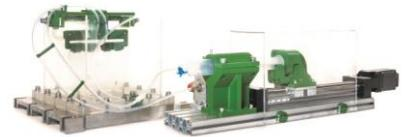
Prüfstand zur Messung der Druck-Volumen-Korrelation von Organen.
