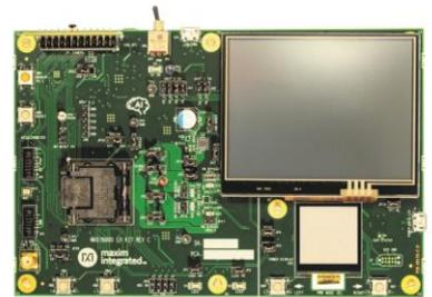
Der MAX78000, eine neue Art von KI-Mikrocontroller, wurde entwickelt, um neuronale Netzwerke bei extrem niedrigem Stromverbrauch auszuführen und am Rande des IoT zu leben.
