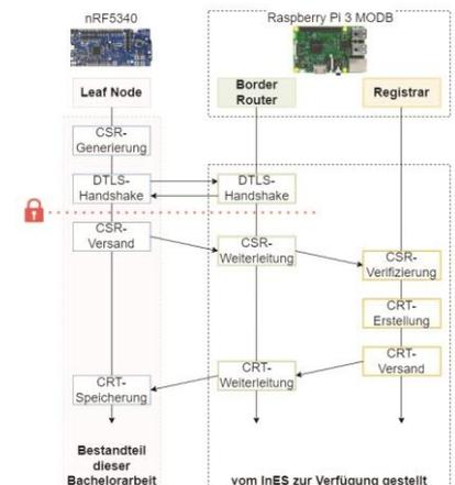
Die Abbildung illustriert die einzelnen Schritte des Enrollment over Secure Transport (EST) Prozesses. Der in vorliegender Arbeit entwickelte Demonstrator implementiert die Schritte des Leaf Nodes. Für deren sicherheitskritische Aspekte baut der Demonstrator auf der TrustZone-Technologie auf. Somit wird sichergestellt, dass die sensitiven Operationen des EST-Prozesses gesichert und isoliert vom Rest der Applikation ausgeführt werden können.
