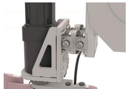
Für das Anfahren verschiedener Anstellwinkel wird ein Getriebemotor eingesetzt. Der Schiebewinkel wird mit Hilfe eines Doppelgelenks eingestellt. Dieses kompensiert den entstehenden Winkel- und Höhenversatz.
