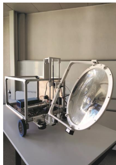
Der Solar-Terminator, zu sehen mit seiner Linse, welche ausgerichtet werden kann, um Unkraut zu denaturieren. Dafür erkennt eine in Fahrrichtung ausgerichtete Kamera das Unkraut und richtet die Linse im richtigen Winkel zur Sonne aus.
