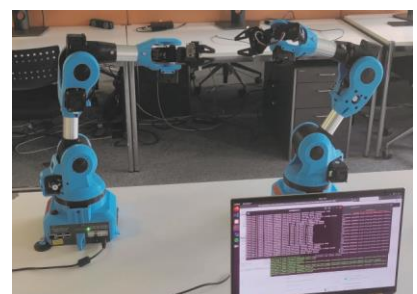
Der Aufbau der zwei Roboter zur Demonstration der Funktionalitäten, synchron und asynchron Trajektorien ausführen zu können
