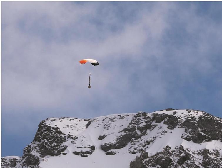
Nachdem der Helikopter die Rakete auf etwa 900m fallengelassen hat, fliegt sie, aufgehängt am Fallschirm, autonom Richtung Boden. Während dem ganzen Flug werden Sensordaten an die Bodenstation gesendet. Am Boden werden die Werte überwacht und wenn nötig eine Sicherheitsspirale eingeleitet.
