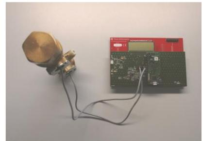
Hier wird der Messaufbau des Enproduktes dargestellt. Das rote bestehende UFM System, darauf die PCB Erweiterung und daneben die Messstrecke (Audiowell).
