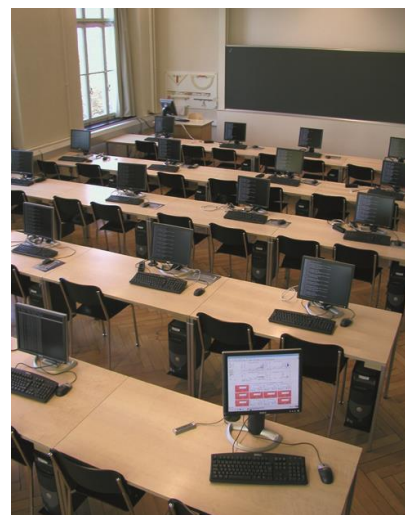
Obenstehend ist ein, für das Projekt typischer, Cluster abgebildet. Dabei handelt es sich um einen üblichen Informatik-Schulraum mit 21 Arbeitsplatzrechnern. Diese verfügen über einen 2,6 GHz Intel Pentium 4 Prozessor mit Hyper Threading Technologie und 512 MB RAM, sowie über einen Anschluss an ein 100 MBit/s schnelles Netzwerk.
