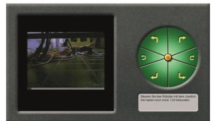
Webinterface zur Steuerung des Fahrzeugs.
