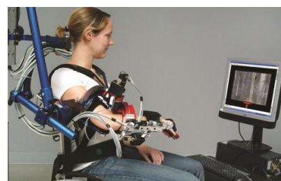
Bei der interaktiven Rehabilitation mit ARMin werden die Armbewegungen des Patienten erfasst und ins Spiel übertragen. Durch die spielerische Therapie wird die Motivation des zu Therapierenden erhöht.
