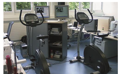
Testaufbau mit zwei Ergometern, die über das Netzwerk gegeneinander ein Rennen fahren.
