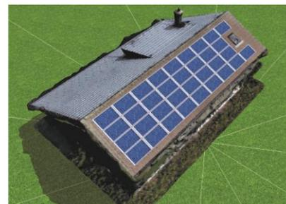
Geplante PV Anlage in der Software PV\*SOL premium basierend auf dem aus Luftfotos erstellten 3D Modell.
