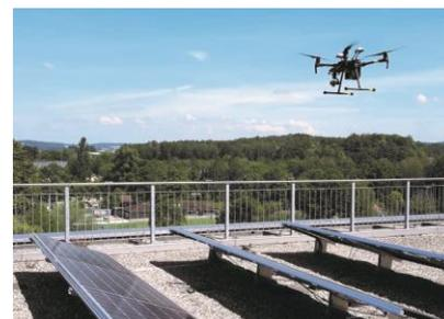
Erfassung der Thermografieaufnahmen von PV Anlagen mittels dem eingesetzten Multikopter DJI M210 RTK für die anschliessende Auswertung in der selbst erstellten Software.
