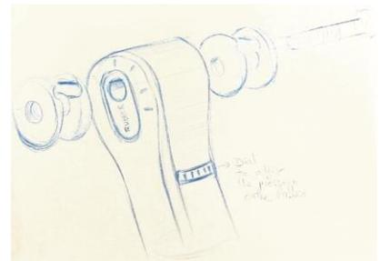
Erste Skizze einer Komfort-Sattelstütze mit integriertem Elastomer; diese soll den Radfahrer vor Strassenvibration isolieren
