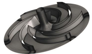
Abbildung 1: Laufradkomponente für die mechanisch-hydraulische Energieumwandlung in einer Kreiselpumpe
