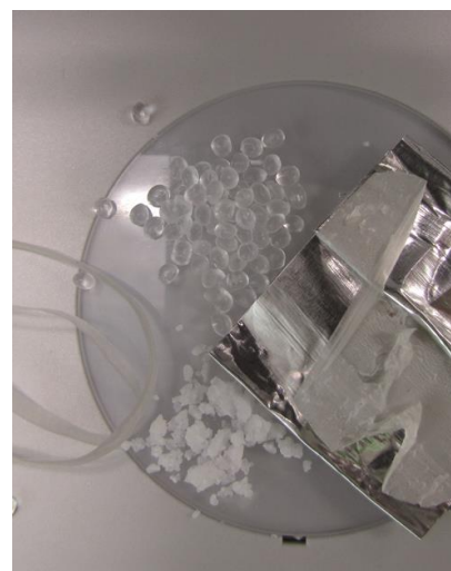
In der Abbildung sind transparent das Polyethylengranulat, weiss das Maleinsäureanhydrid Pulver, ein extrudierter Strang sowie eine Verklebung des hergestellten Produktes auf Aluminium zu sehen.
