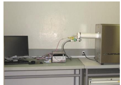
Prüfstand zur Messung der elektrischen Leitfähigkeit bei hohen Temperaturen
