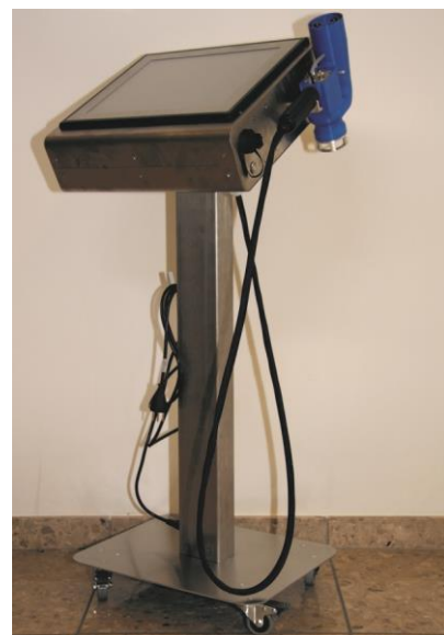
Bedienpult mit Handgerät zur Detektion von Hautkrebs in der Halterung
