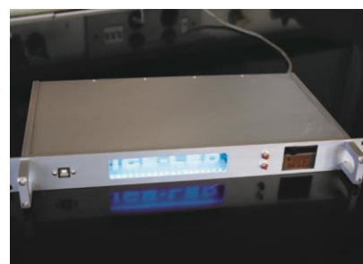
DVI-Modul für Bilddatenaufbereitung
