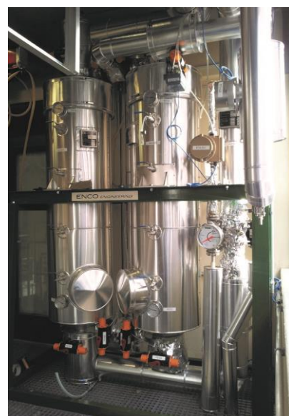
Herzstück der neuen Pressure Swing Adsorption Pilot-Anlage: Adsorber A&B, Inhalt je ca. 180 kg Zeolith
