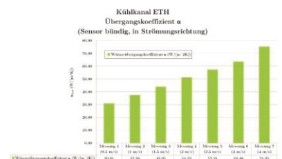
Resultate der Wärmeflussmessungen bei der ETH (Wärmeübergangskoeffizienten von der Schokoladenlinse zur Umgebung).
