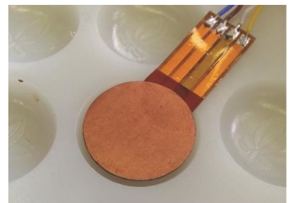
Speziell angefertigter Wärmeflussensor für die Schokoladenform aus Kapton, Kupfer und Konstantan.
