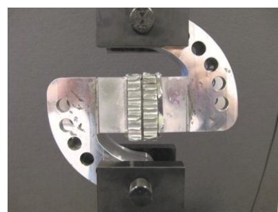
Testaufbau für reine Schubspannungsbelastung
