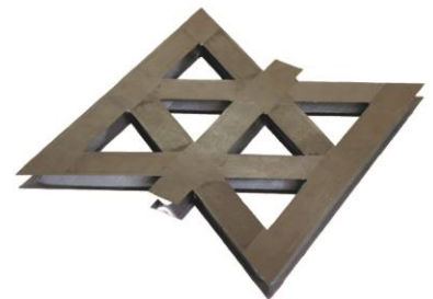
Das mit unidirektionalem Carbon-Prepreg und einem Schaumstoffkern hergestellte Testmuster.
