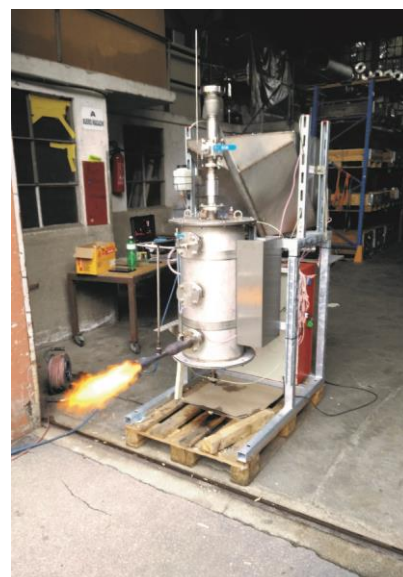
Experimentalholzvergaser im Gleichstrombetrieb mit Lanze während eines Versuches.
