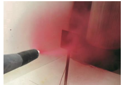
Diese Abbildung zeigt die Partikelwolke beim Pulverbeschichtungsprozess.
