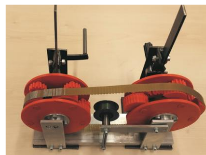
Dies ist der Prototyp des Exzentrerscheibenantriebs, welcher das erste Konzept des stufenlosen Antriebs darstellt. Die Bauteilkomponenten sind teils Druckteile aus dem ZPP und teils selber gefertigte Bauteile.
