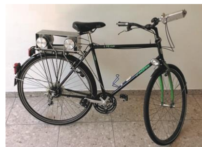
Das Bild zeigt das komplette Fahrrad mit dem Variomatik-Zwischengetriebe und der stufenlosen Schaltung über den Bowdenzug vom Lenker. Die meisten Bauteilkomponenten wurden selber gefertigt.
