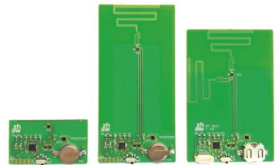
Drei verschiedene Antennen-Designs des Sensor-Tags (Slot, Monopole, Dual-Monopole)
