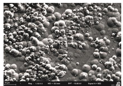
REM Aufnahme der Oberfläche einer stromlos abgeschiedenen Nickel- Keramik-Nickelhybridbeschichtung
