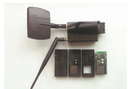
Realisiertes Funktionsmuster bestehend aus den drei BLE Tags (unten: von links nach rechts) TurnTag, PushTag, CombinedTag und dem Controller (oben).
