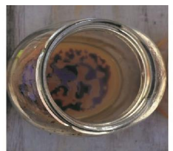
Kondensatausscheidung mit Teerablagerungen und Holzessig
