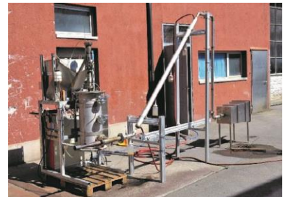
Versuchsaufbau mit Wärmetauscher und Filtergehäuse
