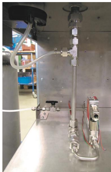
Links der komplette Messaufbau des Druckverlust-Prüfstandes im messenden Zustand und rechts eine Vergrößerung der Messsensor Anordnung.
