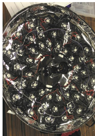
Beleuchtungseinheit mit RGBW, IR LEDs und einer CCD Kamera installiert
