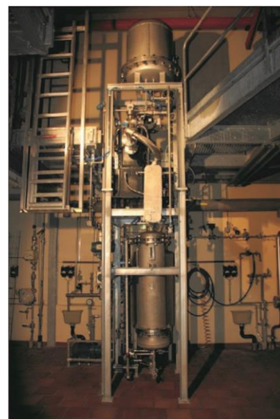
Die Pilotpervaporationsanlage der ZHAW, welche für die Versuche mit Methanol eingesetzt wurde.
