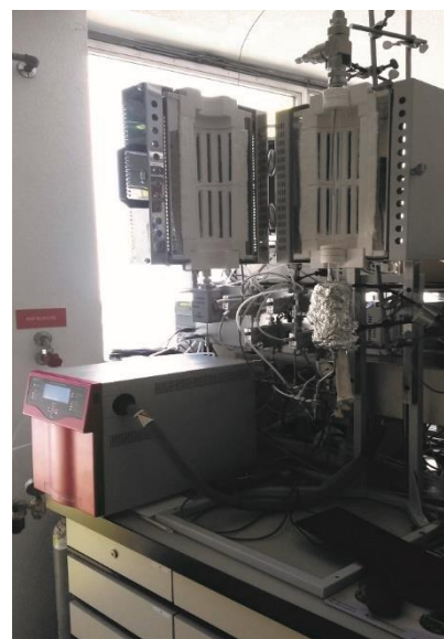
Versuchsreaktor (rechts) und Online-Massenspektrometer (links) zur Untersuchung der neuen Abgaskatalysatoren.
