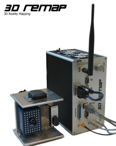
Multisensormodul bestehend aus einer Tragereinheit für diverse Sensoren (links) und einer Rechereinheit für die Verarbeitung und Übermittlung der Daten (rechts)
