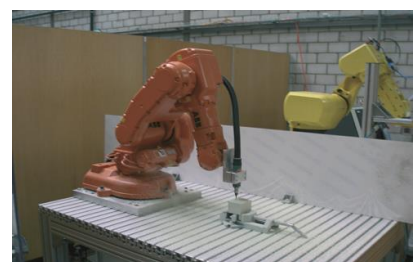
ABB IRB 140 Roboter mit Druckluftspindel bearbeitet ein Werkstück mit komplexer Oberfläche.
