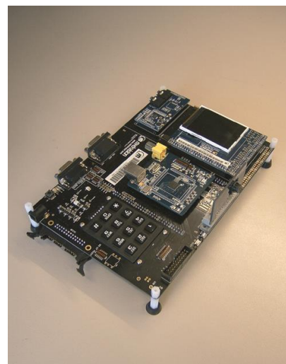
Omnivision CMOS-Kamera auf einem Evaluationsboard und Texas Instruments DaVinci-Videoprozessor Evaluationsboard.
