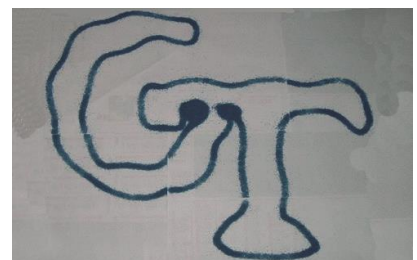
Mit Sand als Schreibgerät wurde "GT" mit dem portablen Brückenkran geschrieben. Dank der Input-Shaper-Technologie konnte der Text beinahe perfekt wieder gegeben werden.
