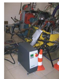
Beschaffenes Temperiergerät im Einsatz am Motorenprüfstand der EMPA
