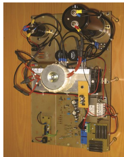
Das Gleichrichtmodul wird durch den Kühlkörper in zwei Halften geteilt. Auf der unteren Hälfte ist die gesamte Logik inklusive Mikroprozessor und auf der oberen Seite der Hauptstromkreis aufgebaut. Gut ersichtlich auf den Kühlkörper ist der Hochfrequenztransformator montiert.
